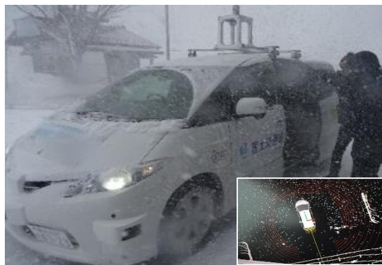
〈降雪をLiDARで検知したことによる走行性能の低下が発生〉
