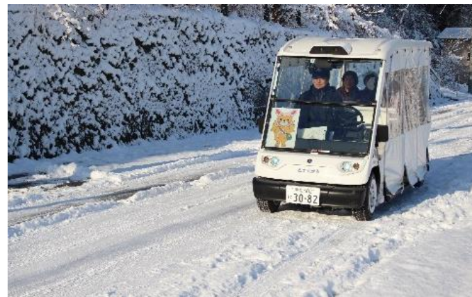
〈電磁誘導線により概ね円滑な走行を確認〉
