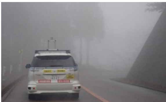
〈霧をLiDARで検知したことによる走行性能の低下が発生〉
