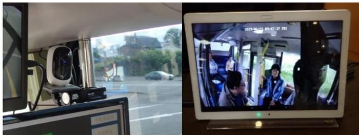
車内をモニタリングする車載カメラ
